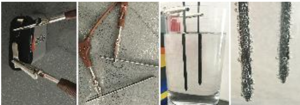
Figura 10: L'idrogeno può essere prodotto in cucina con l'aiuto di una batteria, due mine delle matite come elettrodi e un po' di acqua salata.
