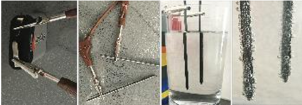
Fig. 6: Hidrogenul poate fi produs acasă cu ajutorul bateriilor, două creioane de grafit ca electrozi și puțină apă sărată.
