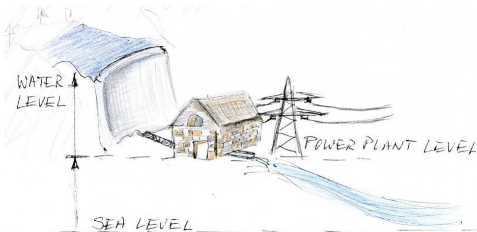
Fig 5: Dacă numărăm altitudinile din munți și văi în raport cu nivelul mării, doar o parte din energia care poate fi transferată de apa care curge din munți în mare este utilizată în centrala electrică la jumătatea drumului spre mare.
