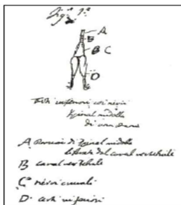
Rys. 1. Schemat doświadczenia Volty ilustrujący połączenie dwóch różnych metali do nerwów i mięśnia żaby [2]
